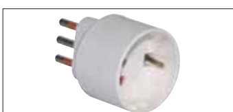
Adattatore semplice 2P+T - Max 1500W - 250V~ - 10A - una presa 2P + T standard Italiano e Tedesco tipo P30 - Una spina 10A 2P + T standard Italiano tipo S11 Simple adapters 2P+T - Max 1500W - 250V~ - 10A - One Italian and German standard socket 2P + T P30 type - One Italian standard plug 10A 2P + T S11 type
