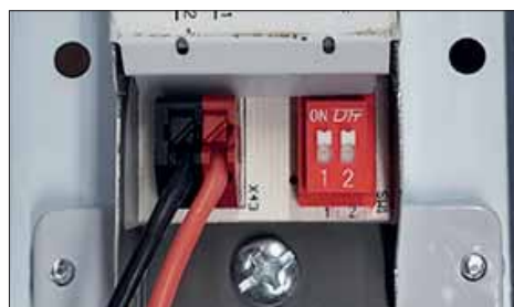
Dip switch per la selezione della corrente in uscita Equipped with dip switch for selection the output current
